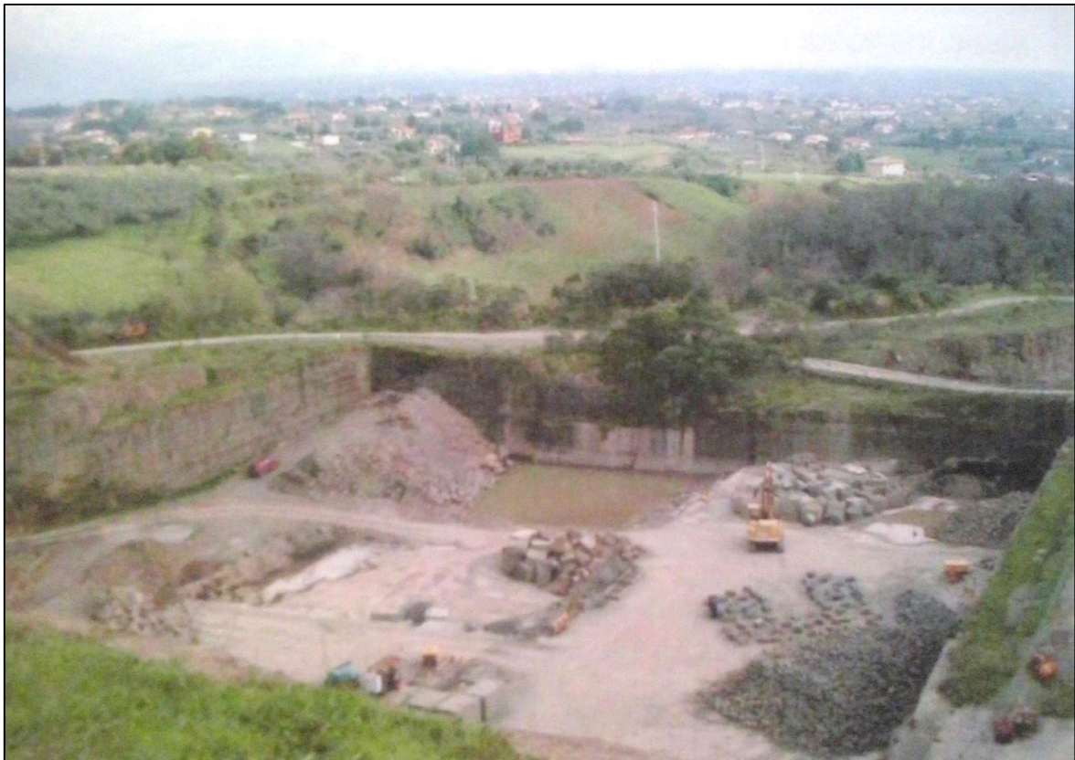
Figura 39 – Fossa per la raccolta delle acque di lavorazione e meteoriche.
